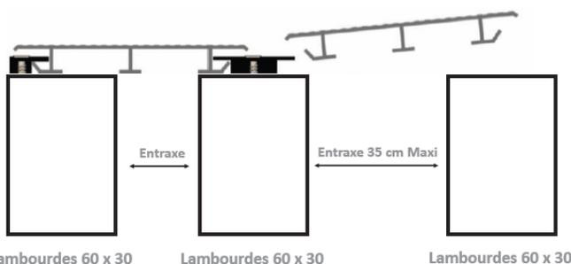
Le clip de fixation permet à la fois de venir bloquer la lame sur la lambourde mais aussi de définir automatiquement un espacement de 5mm entre 2 lames.
